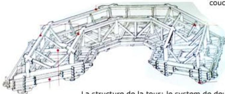
La structure de la tour: le system de deux couches de tubes est utilisé pour la tour nuage moderne
