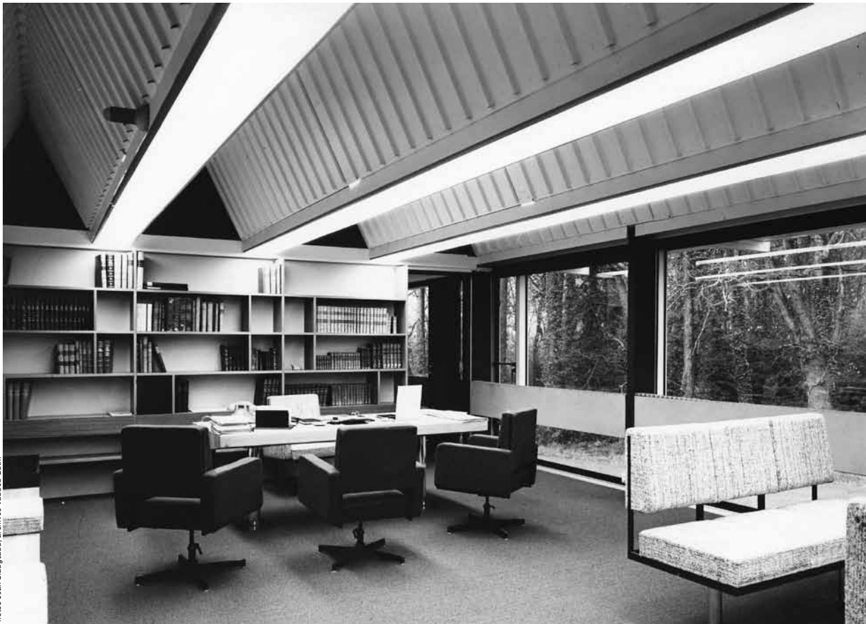
Administration, étage. La toiture plissée dispense une abondante lumière naturelle, tandis que les façades vitrées toute hauteur estompent la limite entre le dedans et le dehors.
